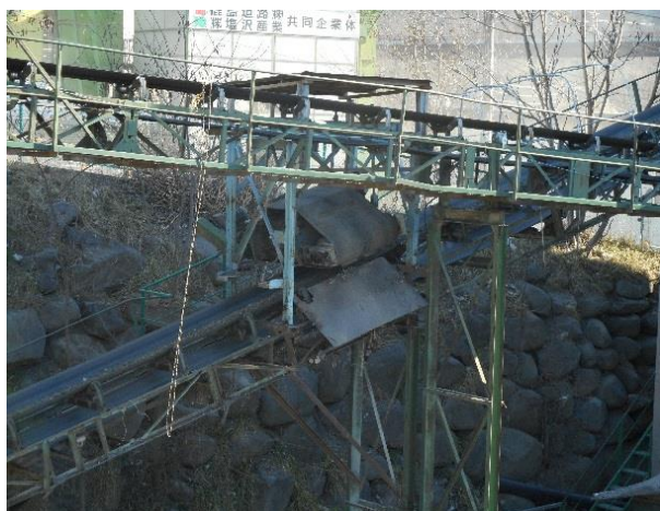
⑤ 磁選機により鉄筋を省きます
